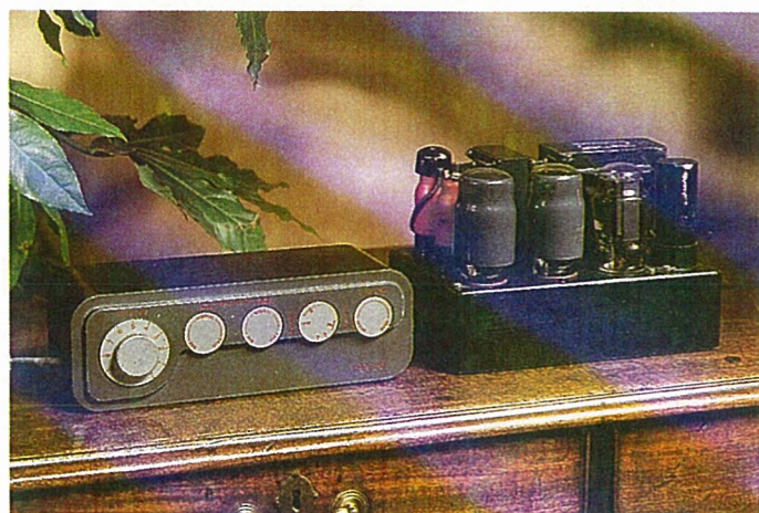
1951 Acoustical Q.U.A.D. (Quality Unit Amplifier Domestic) kontrol- og effektforstærker. Som en logisk videreudvikling af QA12/P viste dette sæt nye veje med idéen om en separat kontrollforstærker med filtre til at fjerne uønsket støj fra pladegengivelsen.
