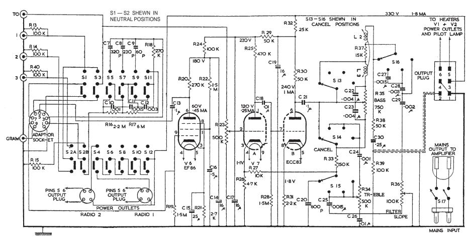
SWITCH GANGING: - S1-S2A-S2B S3-S4 S5-S6 S7-S8 S9-S10 S11-S12 S13-S14-S15-S16
